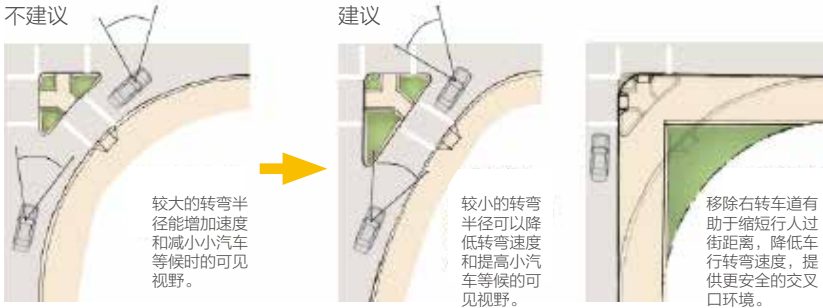
图 3-90 | 通过减小转弯半径和移除右转车道保障更安全的交叉口环境
