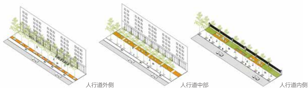
图 3-41 | 设施带总体布置示意
