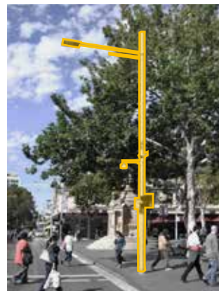
图 3-46 | 尽量对地面杆线作合杆设置处理
