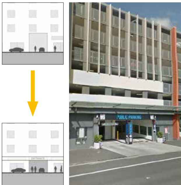
图 3-18 | 车行出入口不应破坏立面的完整性
