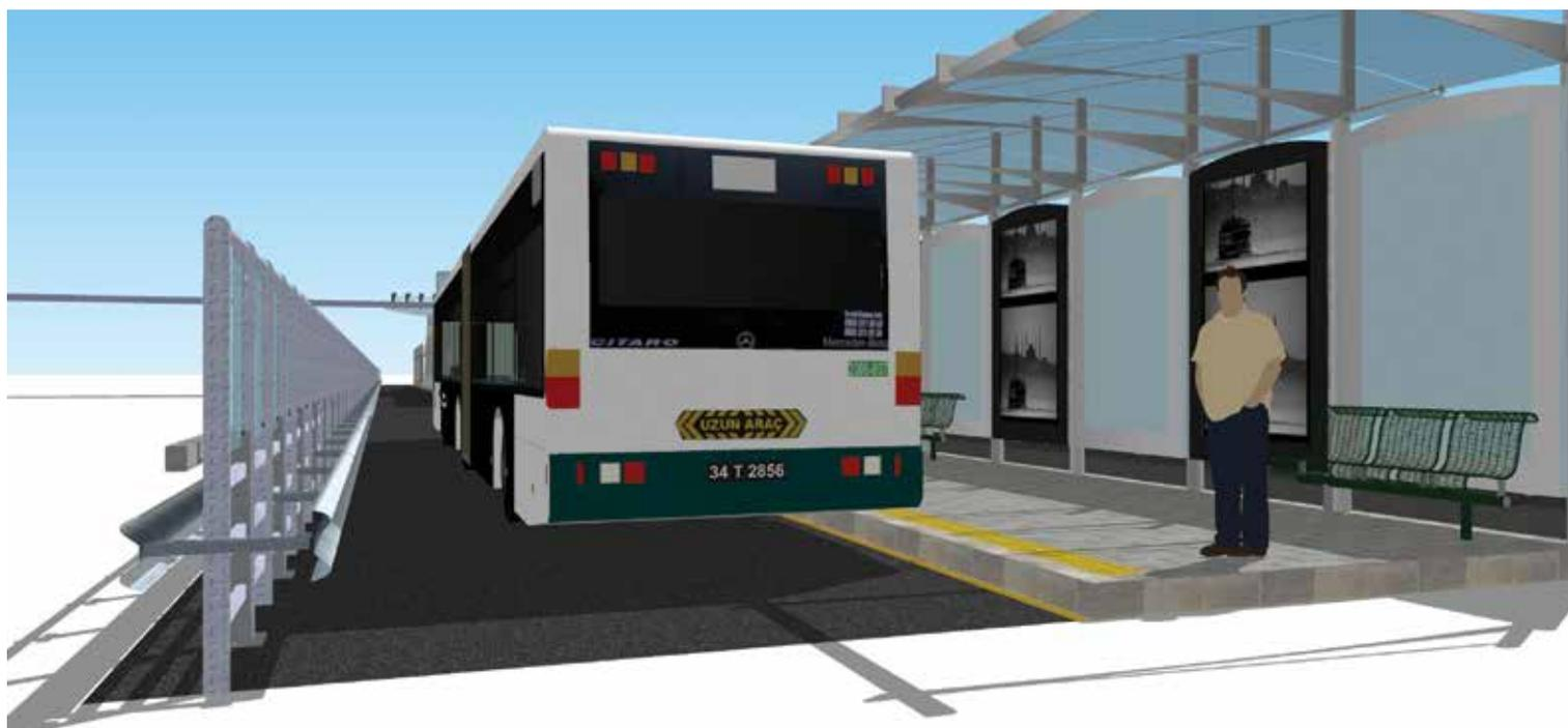
图 68 图解双侧防撞隔挡及高护栏的设计要求，建议应用在高速路BRT系统上
