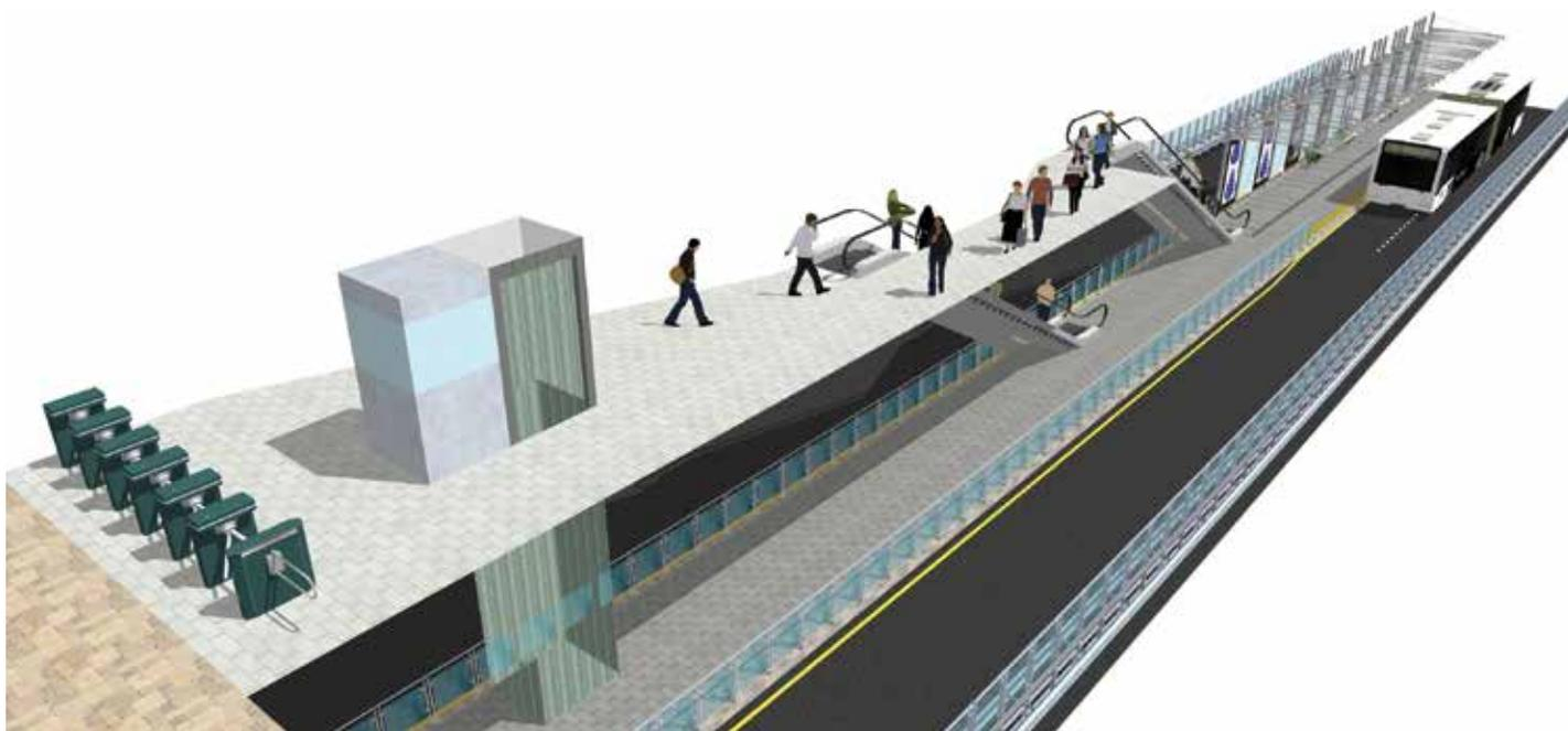
**图 69** 通过优化车站设计，增加乘客承载力，缓解高速路中央BRT车站的人流拥挤。图中所示部分为乘客入口的示意图，不包括需要的护栏。
