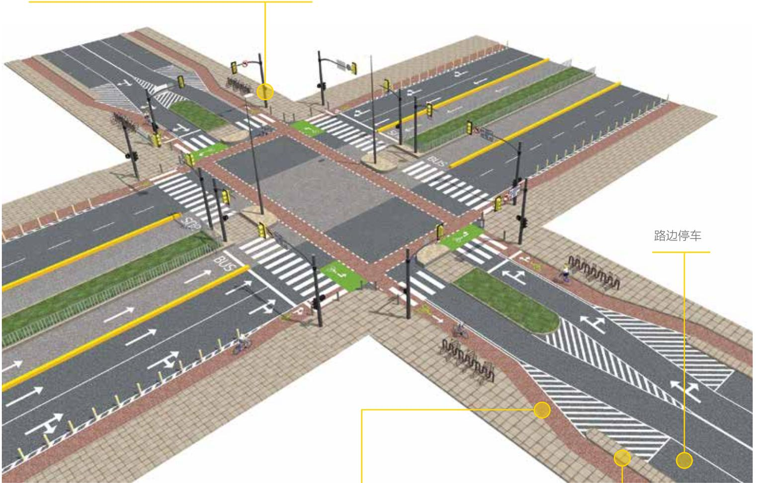
图 35 带自行车转弯带的小型十字路口
